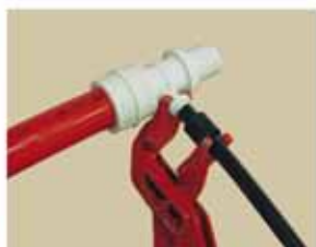
5. Felhelyezzük a megfelelő méretű prérsszerszámot.
