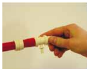
4. Az idomot betoljuk a feltágított csőbe ütközésig.
