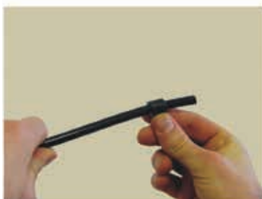
1. A szorítóhüvelyt felhelyezzük a csőre még a tágitás előtt.
